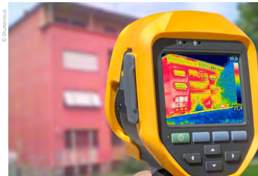
*** Grâce à l'utilisation d'une caméra thermique, il vous sera possible de comprendre comment la chaleur s'échappe des habitations.
